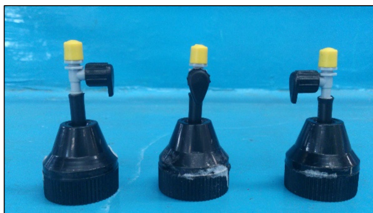
Figura 17.- Adaptación rociadores para dispersión de carga hidráulica marca Orbit.
